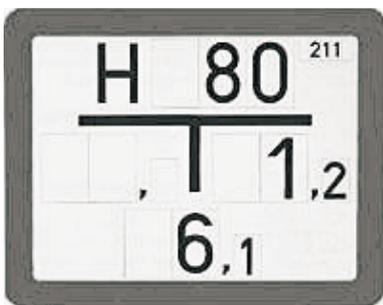
Beispiel: Dieser Hydrant wäre 6,10m vor dem Schild und 1,20m rechts davon. Die Leitung hat einen Durchmesser von 8cm, was für die Feuerwehr etwa 800l/min bedeutet. Zum Öffnen der Unterflurhydranten benötigt man einen Unterflurhydrantenschlüssel und zur Wasserentnahme ein Standrohr.
